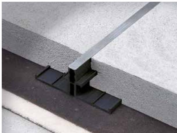
Junta indicada para la colocación con mortero, realizado en material sintético de doble densidad. Está constituido por dos partes estructurales rígidas unidas por inserciones de material plastificado blando, disponibles en varios colores. La junta CMB se utiliza para fraccionar la solera según lo previsto en el proyecto.
